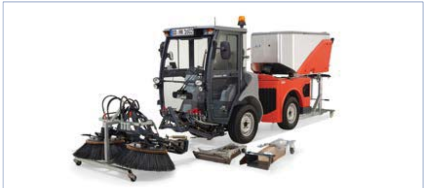
Das Wechseln der Anbauten, kann von einer Person allein und ohne den Einsatz von Werkzeugen einfach, sicher und rüchenschonend erledigt werden
