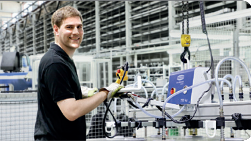
Vakuum-Hebegeräte VacuMaster heben und bewegen schwere und großflächige Werkstücke wie Bleche, Fenster oder Kunststoffplatten.
