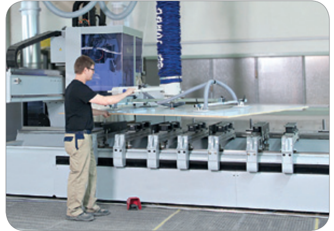
Perfekte Kombination: Aluminium-Schwenkkrane und Vakuum-Schlauchheber JumboErgo beim Be- und Entladen eines CNC-Bearbeitungszentrums.
