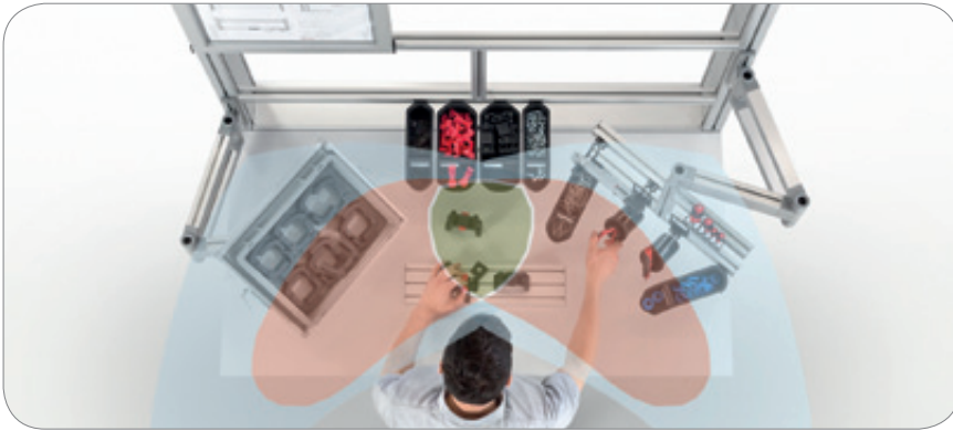
Sollen Arbeitsplätze in der manuellen Montage ergonomisch sein, muss vor allem auch der Greifraum mit einbezogen werden.
