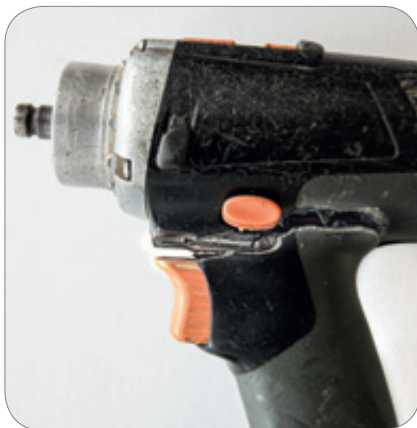
Beispiel eines durch Überbeanspruchung gebrochenen Schraubgerätes
