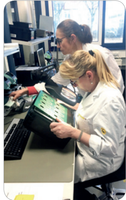
Lösungen liegen oft auf der Hand. Die Erhöhung der zu bestückenden Leiterplatte bringt Entlastung.
