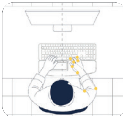
Top-Down-Ansicht auf die Markerplatzierung während der Bewegungsanalyse (links: Haltung mit Contour Touch, rechts: Haltung mit Standard-Maus)
